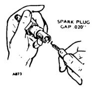
FIGURE 18. SPARK PLUG GAP
