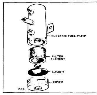
FIGURE 19. FUEL PUMP FILTER ELEMENT
