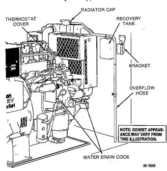
FIGURE 7. TYPICAL COOLING SYSTEM COMPONENTS
