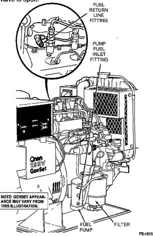
FIGURE 9. INJECTION PUMP FUEL SYSTEM
