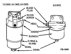
FIGURE 10. FUEL FILTER ASSEMBLY
